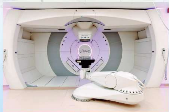
ProBeam 360° 質子治療系統
